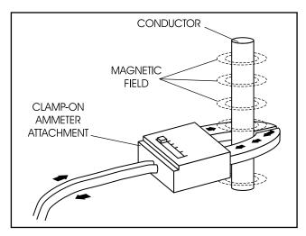
Figure 14. Clamp-On Ammeter
